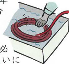
ホースは定期的に硬化したり、磨耗したり、亀裂がないか必ず点検し、異常があればガス漏えいによる事故の起きるおそれがあるので、ただちに新品と交換しましょう。
