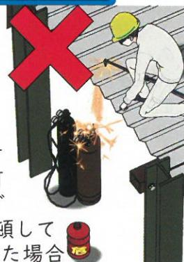
また溶接溶断の火花の飛来する場所には、容器・ホース、可燃物等は置きません。LPガスでは、作業を行う周辺を、整理整頓して十分な通気を確保し、漏えいした場合の滞留防止措置をとっておきましょう。
